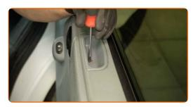
Entfernen Sie die Abdeckung der Türgriffverkleidung.
