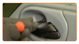
Ziehen Sie die Befestigungsschrauben der Türverkleidung fest. Verwenden Sie einen Kreuzschlitzschraubendreher.
