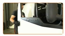
Schrauben Sie die Befestigungsschrauben der Türverkleidung ab. Verwenden Sie einen Kreuzschlitzschraubendreher.
