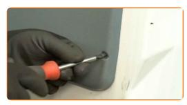
Entfernen Sie die Türverkleidung. Verwenden Sie einen Zierleistenkeil.
