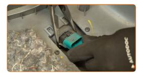
Bringen Sie den neuen Schalter des elektrischen Fensterhebers an der Türverkleidung an.
