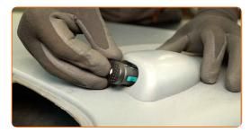
Verbinden Sie den Stecker mit dem Schalter des elektrischen Fensterhebers.
