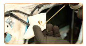
Entfernen Sie den alten Schalter des elektrischen Fensterhebers von der Türverkleidung. Verwenden Sie eine Spitzzange.
