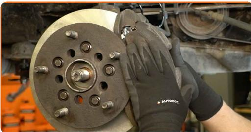
21 Setzen Sie die Befestigungsschrauben ein.
