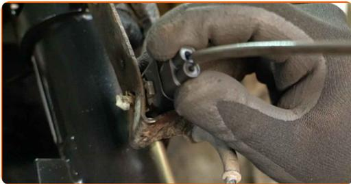
19 Befestigen Sie den neuen Bremsbelagfühler am inneren Bremsbelag.
