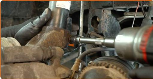
**41** Entfernen Sie die Befestigungsschraube.
