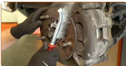
**81** Reinigen und schmieren Sie die Oberfläche der Radnabe, die die Felge berührt. Verwenden Sie Keramikfett.
