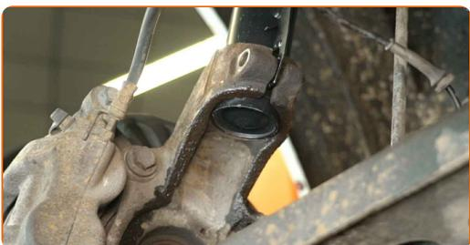
**66** Setzen Sie die Befestigungsschraube ein und schrauben Sie sie fest.
