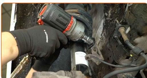
**22** Entfernen Sie die ABS-Sensorkabelhalterung vom Federbein.
