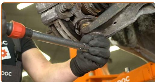
**80** Reinigen Sie die Kontaktfläche der Radfelge. Benutzen Sie eine Drahtbürste. Verwenden Sie ein Allzweck-Reinigungsspray.
