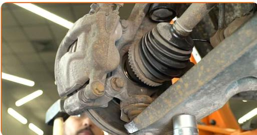
**29** Entfernen Sie die Stütze unter dem Achslenker.
