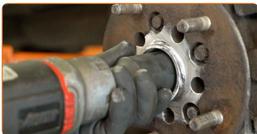
**26** Entfernen Sie die Unterlegscheibe der Achse. Verwenden Sie einen Teleskop-Magnetheber.
