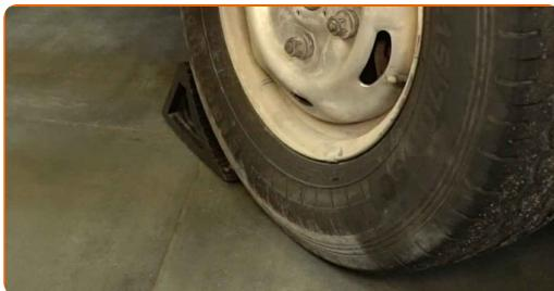
**4** Lockern Sie die Radmuttern. Verwenden Sie eine Schlagnuss für Felgen mit einem Durchmesser von 21 mm.
