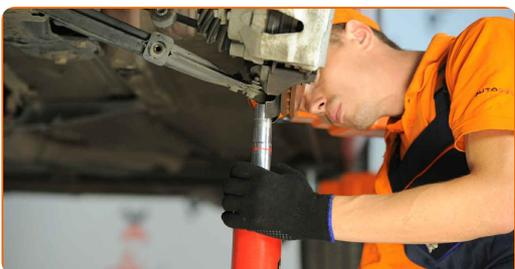
**37** Befestigen Sie das Dämpferbein auf dem Achsschenkel. Benutzen Sie einen Hammer.
