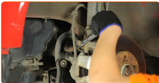
**12** Entfernen Sie die Befestigungsschraube.
