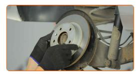
Reinigen Sie die Nabe. Benutzen Sie eine Drahtbürste. Behandeln Sie die Kontaktfläche. Benutzen Sie ein Kupferschmiermittel.
