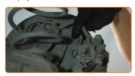
Lösen Sie die Befestigung der Sattelhalterung. Verwenden Sie Stecknuss Nr. E18. Verwenden Sie einen Ratschenschlüssel.
