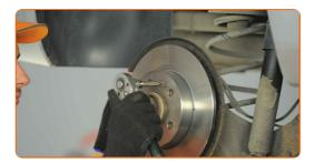
Reinigen Sie den Montageort von Bremssattel sowie seiner Halterung. Benutzen Sie eine Drahtbürste. Benutzen Sie WD-40-Spray.
