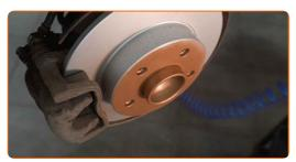
Die Bremsscheibenoberfläche reinigen. Benutzen Sie einen Bremsenreiniger.
