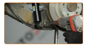
Entfernen Sie die Befestigungsschraube.
