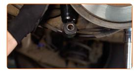
Die Montage unter dem Hinterachsträger entfernen.
