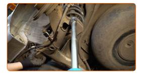
Ziehen Sie den unteren Befestiger des Stoßdämpfers an. Verwenden Sie Stecknuss Nr. E20. Verwenden Sie einen Drehmomentschlüssel. Ziehen Sie ihn mit 130 Nm Drehmoment fest.
