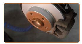
Die Bremsscheibenoberfläche reinigen. Benutzen Sie einen Bremsenreiniger.
