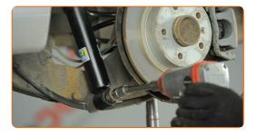
Die Montage unter dem Hinterachsträger entfernen.
