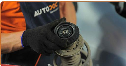
**24** Installieren Sie das Federbein am Radlauf.
