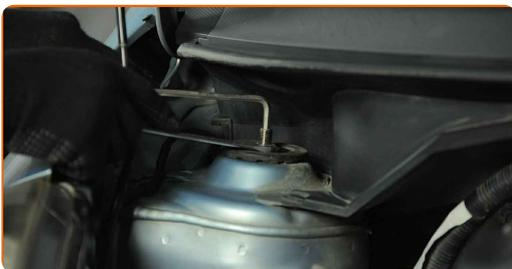
**26** Entfernen Sie die Kotflügel-Abdeckung.
