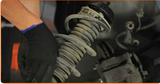
**25** Ziehen Sie die obere Befestigung des Domlagers fest. Verwenden Sie Ring-Gabelschlüssel Nr. 17. Verwenden Sie Inbusschlüssel Nr. H7. Verwenden Sie einen Drehmomentschlüssel. Ziehen Sie ihn mit 44 Nm Drehmoment fest.
