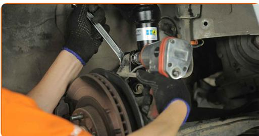
**16** Entfernen Sie die Befestigungsschrauben (2 Stück).
