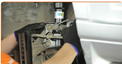
**11** Entfernen Sie die Halterung des ABS-Kabelbaums.
