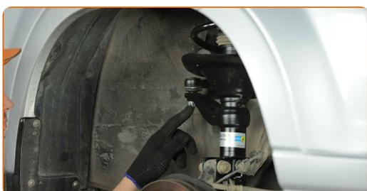
**8** Lösen Sie das Ende der Befestigungsmutter an dem Achsschenkel. Verwenden Sie Ring-Gabelschlüssel Nr. 17.
