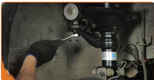
**52** Bringen Sie den Splint an. Verwenden Sie eine Kneifzange.
