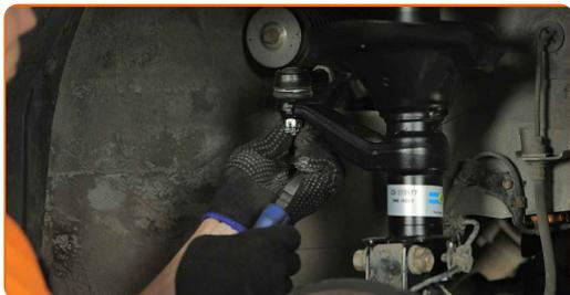
**53** Behandeln Sie die Federbein-Befestigungen. Behandeln Sie das Befestigungselement, das den Spurstangenkopf mit dem Achsschenkel verbindet. Benutzen Sie ein Kupferschmiermittel.
