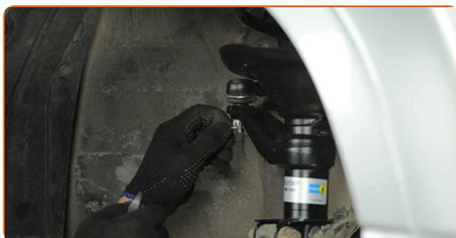
**7** Reinigen Sie das Befestigungselement, das den Spurstangenkopf mit dem Achsschenkel verbindet. Benutzen Sie eine Drahtbürste. Benutzen Sie WD-40-Spray.
