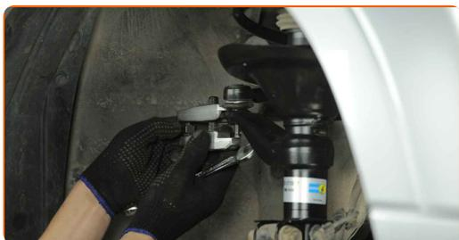
**10** Schrauben Sie den ABS-Kabelhalter ab. Verwenden Sie Stecknuss Nr. 10. Verwenden Sie einen Ratschenschlüssel.
