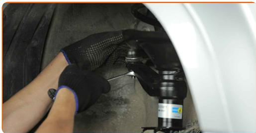
**9** Ziehen Sie den Spurstangenkopf vom Achsschenkel. Verwenden Sie einen Kugelgelenkabzieher.
