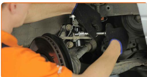
**13** Entfernen Sie die Halterung der Stoßdämpferstrebe.
