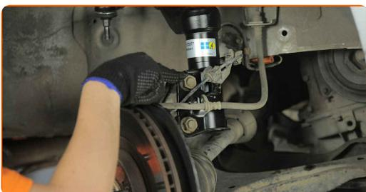
**15** Schrauben Sie das untere Befestigungselement ab, das das Federbein mit dem Achsschenkel verbindet. Verwenden Sie Ring-Gabelschlüssel Nr. 19. Verwenden Sie Stecknuss Nr. 22. Verwenden Sie einen Ratschenschlüssel.
