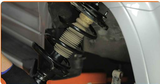
**37** Schrauben Sie die obere Befestigung des Federbeinbefestigung an.
