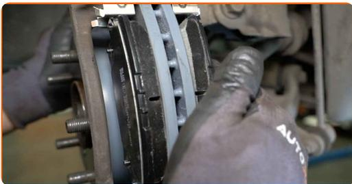
**38** Bauen Sie den Bremssattel ein und befestigen Sie diesen.
