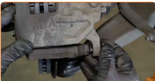
**40** Ziehen Sie die Bremssattelbefestigungen fest. Verwenden Sie Ring-Gabelschlüssel Nr. 17. Verwenden Sie Stecknuss Nr. 13. Verwenden Sie einen Drehmomentschlüssel. Ziehen Sie ihn mit 35 Nm Drehmoment fest.
