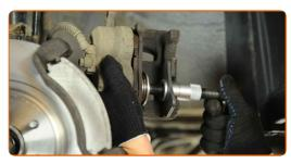
Installieren Sie den Bremssattel und fixieren Sie diesen.
