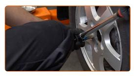
27 Entfernen Sie den Wagenheber sowie die Unterlegkeile.
