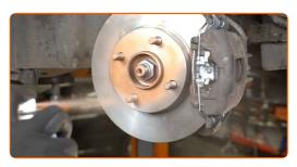
Die Bremsscheibenoberfläche reinigen. Benutzen Sie einen Bremsenreiniger.
