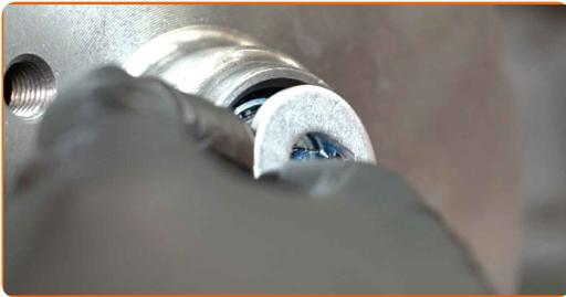
**14** Schrauben Sie die Nabenmutter an. Verwenden Sie Stecknuss Nr. 30. Verwenden Sie einen Ratschenschlüssel.
