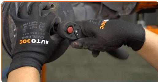
**9** Entfernen Sie die Befestigungsmutter.
