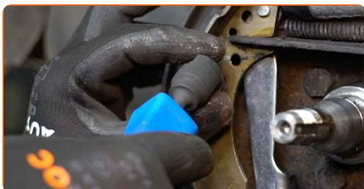
**15** Drücken Sie den Radzylinder zusammen. Verwenden Sie eine Wasserpumpenzange.
