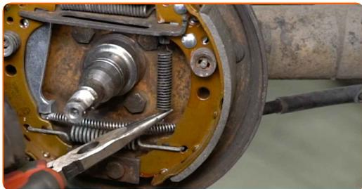
**26** Bauen Sie die obere Rückholfeder ein. Verwenden Sie einen flachen Schraubendreher.
