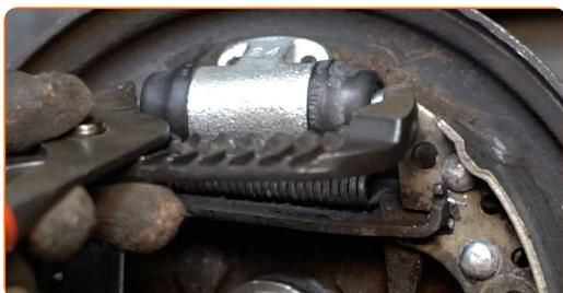
**16** Entfernen Sie beide Beläge von dem Träger. Benutzen Sie ein Brecheisen.
