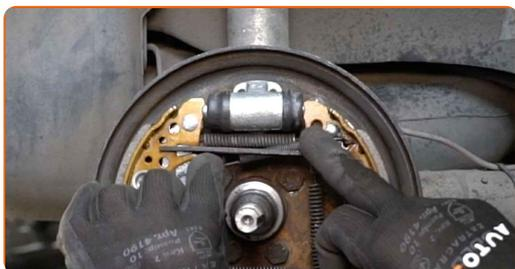
**27** Reinigen Sie den Einbauort für die Nabenlagerung. Benutzen Sie WD-40-Spray.
