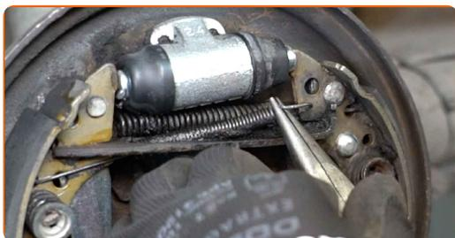
**14** Entfernen Sie den Federteller der Bremsbacken. Verwenden Sie ein Werkzeug für Bremsträgerfedern.
