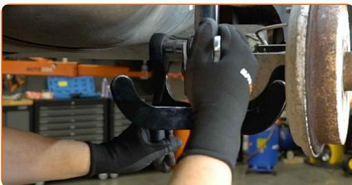
**15** Lösen Sie die obere Befestigung des Domlagers.
