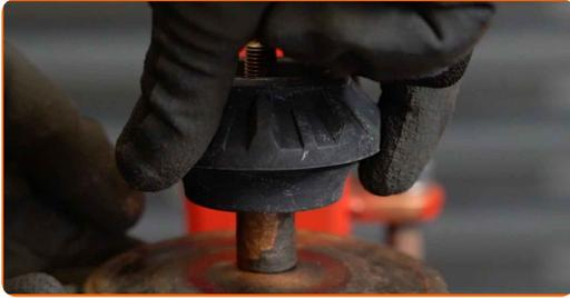
**23** Entfernen Sie das zusammengebaute Federbein.
