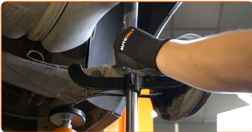
**14** Untere Befestigung der Stoßdämpferfedern abschrauben. Verwenden Sie Ring-Gabelschlüssel Nr. 17. Verwenden Sie Stecknuss Nr. 17. Verwenden Sie ein Windeisen.
