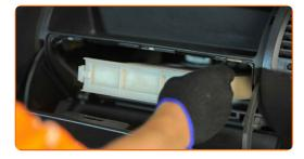
Bringen Sie die Kunststoff-Ablage im Handschuhfach-Inneren an. Stellen Sie sicher, dass Sie dabei das Klicken hören, welches entsteht, wenn sich diese in der korrekten Position befindet.
