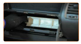
Entfernen Sie das Innenraumfiltergehäuse.
