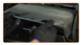
Lösen Sie die Befestigungsclips der Innenraumfilterabdeckung.
