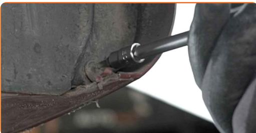
**5** Entfernen Sie die Radkastenabdeckung.
