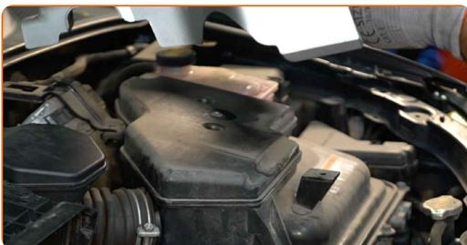
**14** Schrauben Sie die Befestigungen des Luftfilterkastens heraus. Verwenden Sie Stecknuss Nr. 10. Verwenden Sie einen Ratschenschlüssel.
