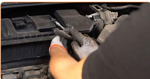
**19** Entfernen Sie das Luftfiltergehäuse.
