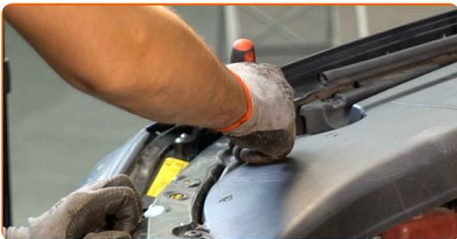
**21** Entfernen Sie die Batteriehaube.
