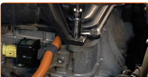
**15** Entfernen Sie den Luftfilterkasten.
