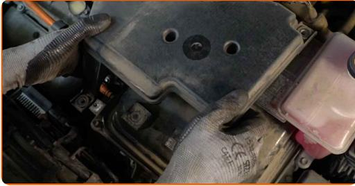
**16** Ziehen Sie den Stecker des Luftmassenmessers ab. Verwenden Sie einen flachen Schraubendreher.
