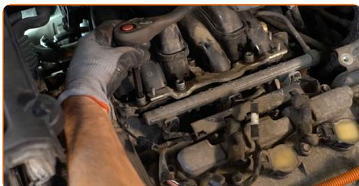
**38** Reinigen Sie die Befestigungen des Ansaugkrümmers.
