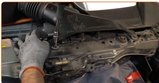
**102** Schrauben Sie die Befestigungsklemme ein, die das Luftkanal-Gehäuse mit dem Luftfilter-Gehäuse verbindet. Verwenden Sie Stecknuss Nr. 10. Verwenden Sie einen Ratschenschlüssel.
