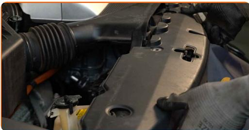
**104** Befestigen Sie die Klammern der Schlossträgerabdeckung.
