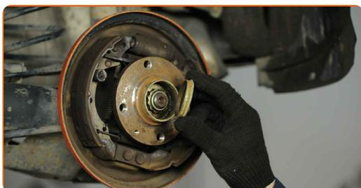
**10** Reinigen Sie das Befestigungselement der Antriebswelle. Benutzen Sie eine Drahtbürste. Benutzen Sie WD-40-Spray.
