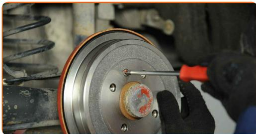
**8** Entfernen Sie die Bremstrommel.
