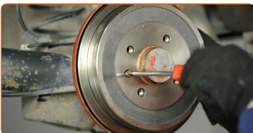
**34** Reinigen Sie die Oberfläche an welcher die Felge montiert werden soll. Benutzen Sie eine Drahtbürste.
