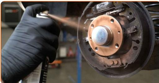
**32** Installieren Sie eine Bremstrommel.
