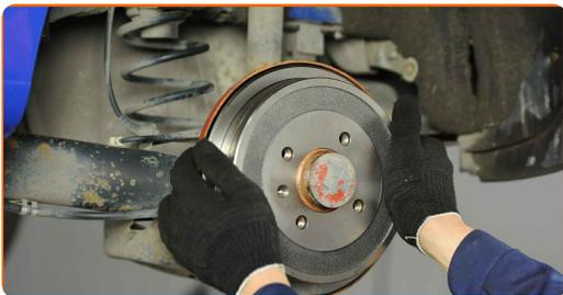
**33** Ziehen Sie die Halteklammern der Bremstrommeln an. Verwenden Sie einen Kreuzschlitzschraubendreher. Verwenden Sie einen Drehmomentschlüssel. Ziehen Sie ihn mit 4 Nm Drehmoment fest.
