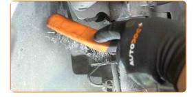
Schrauben Sie das Befestigungselement heraus, das die Druckstange mit dem Federbein verbindet. Verwenden Sie Stecknuss Nr. 17. Verwenden Sie einen Ratschenschlüssel.
