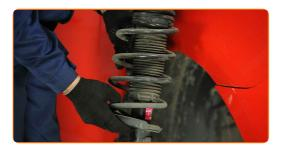
Stellen Sie das Dämpferbein auf das Federspannwerkzeug.
