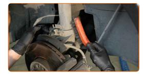
Schrauben Sie das untere Befestigungselement ab, dass das Federbein mit dem Achsschenkel verbindet. Verwenden Sie Stecknuss Nr. 17. Verwenden Sie einen Ratschenschlüssel.
