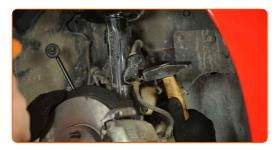
Entfernen Sie den Träger unter dem Achsschenkel.
