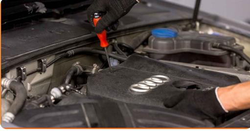
**17** Schrauben Sie die Verbindungselemente der Motorhaube ein. Verwenden Sie einen flachen Schraubendreher.
