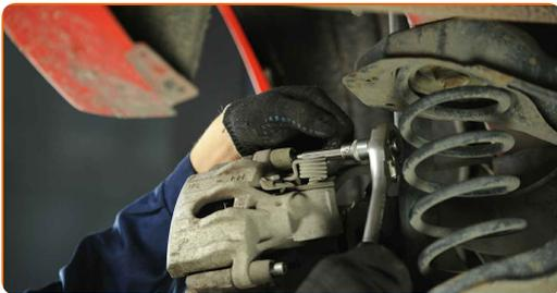
**24** Installieren Sie die Staubschutzkappen der Bremssattel-Führungsstifte.
