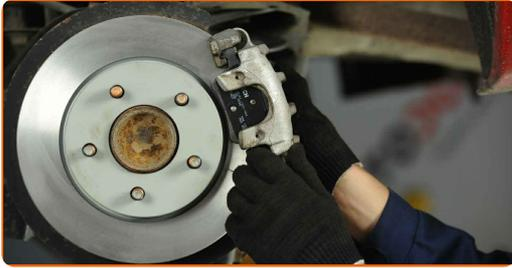
**22** Schrauben Sie die Führungsbolzen hinein.
