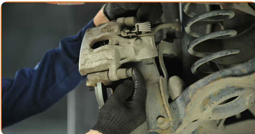
**25** Bauen Sie die Bremssattel-Haltefeder ein. Verwenden Sie einen flachen Schraubendreher.
