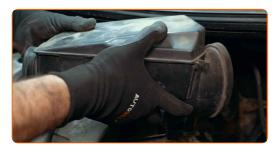
6 Nehmen Sie den Anschluss des Vakuumschlauchs ab.
