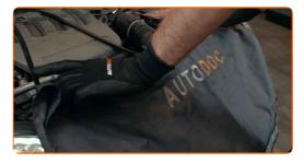
Lockern Sie die Befestigungsklemme, die das Luftkanal-Gehäuse mit dem Luftfilter-Gehäuse verbindet. Verwenden Sie Stecknuss Nr. 7. Verwenden Sie einen Ratschenschlüssel.
