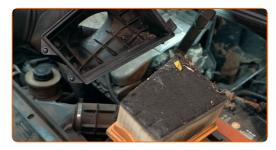
Reinigen Sie das Luftfiltergehäuse.
