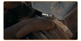
Schrauben Sie die Befestigungsklemme ein, die das Luftkanal-Gehäuse mit dem Luftfilter-Gehäuse verbindet. Verwenden Sie Stecknuss Nr. 7. Verwenden Sie ein Windeisen.
