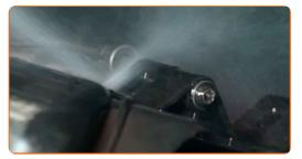
Schrauben Sie die Filtergehäuse-Befestigungsbolzen ab. Verwenden Sie den Torx T20. Verwenden Sie ein Windeisen.
