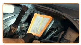
Entfernen Sie das Filterelement aus dem Filtergehäuse.
