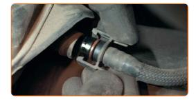
Reinigen Sie die Befestigungen am Luftfiltergehäuse. Verwenden Sie Allzweckreinigungsspray.
