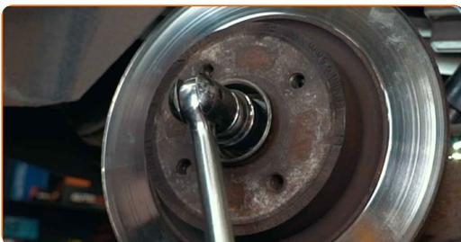
16 Entfernen Sie die mit der Radnabenlagerung zusammengebaute Bremsscheibe.
