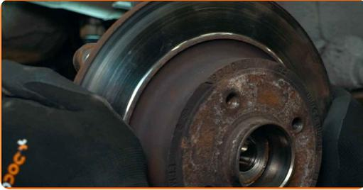
17 Reinigen Sie den Achsschenkel. Benutzen Sie eine Drahtbürste. Verwenden Sie Allzweckreinigungsspray.
