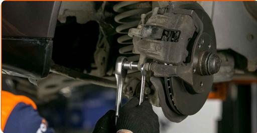
**10** Entfernen Sie die Befestigungsschrauben (2 Stück).
