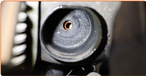
**17** Drehen Sie die untere Befestigung des Motorlagers ein. Verwenden Sie Stecknuss Nr. 16. Verwenden Sie einen Ratschenschlüssel.
