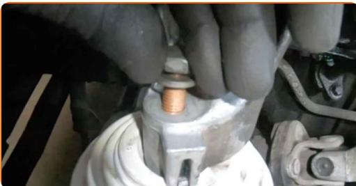
**21** Drehen Sie die obere Befestigung des Motorlagers ein. Verwenden Sie Stecknuss Nr. 16. Verwenden Sie einen Ratschenschlüssel.
