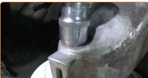
**22** Ziehen Sie das obere Befestigungselement des Motorlagers an. Verwenden Sie Stecknuss Nr. 16. Verwenden Sie einen Drehmomentschlüssel. Ziehen Sie ihn mit 50 Nm Drehmoment fest.
