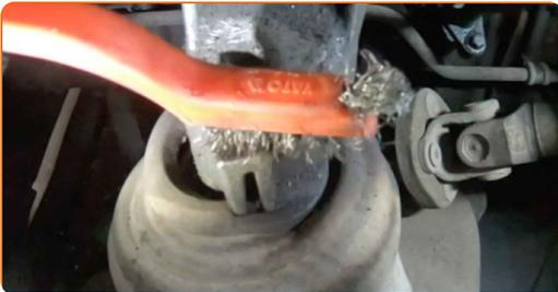
**4** Schrauben Sie das obere Befestigungselement des Motorlagers heraus. Verwenden Sie Stecknuss Nr. 16. Verwenden Sie einen Ratschenschlüssel.
