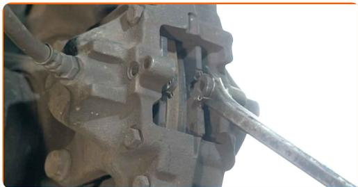
**11** Entfernen Sie die Bremsbeläge.
