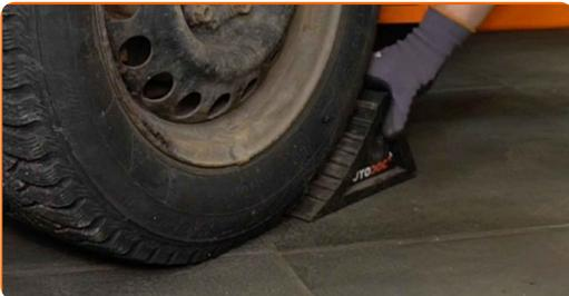
**Austausch: Handbremsbelags – MERCEDES-BENZ CLC (CL203). Tipp von AUTODOC:**
