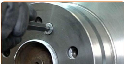
**36** Schrauben Sie die Befestigungen der Bremsscheibe fest. Verwenden Sie Inbusschlüssel Nr. H5. Verwenden Sie einen Drehmomentschlüssel. Ziehen Sie ihn mit 10 Nm Drehmoment fest.
