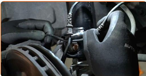
**61** Verbinden Sie das Bremsbelagverschleißkabel.
