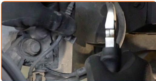
**15** Trennen Sie das Bremsbelagverschleißkabel ab.
