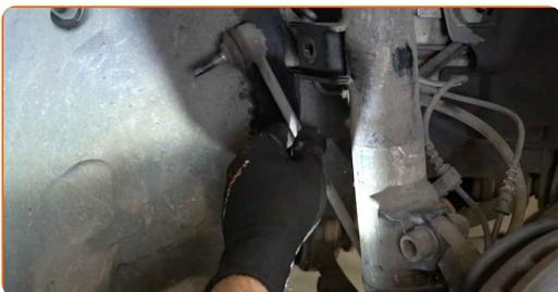
**13** Ziehen Sie den Bremsschlauch Halterung ab. Verwenden Sie eine Kneifzange.
