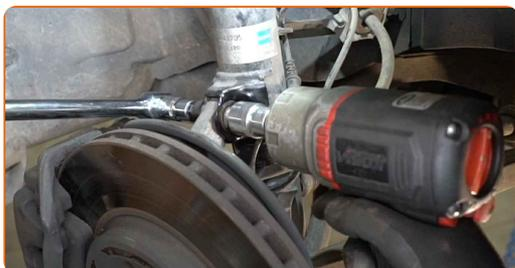
**18** Die Befestigungselemente, die das Federbein mit dem Achsschenkel verbinden, reinigen. Benutzen Sie eine Drahtbürste. Benutzen Sie WD-40-Spray.
