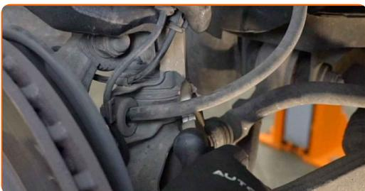
**14** Trennen Sie die Verkabelung des ABS-Sensors.
