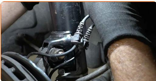
**62** Reinigen Sie die Montagesitze der Koppelstange. Benutzen Sie eine Drahtbürste. Benutzen Sie WD-40-Spray.
