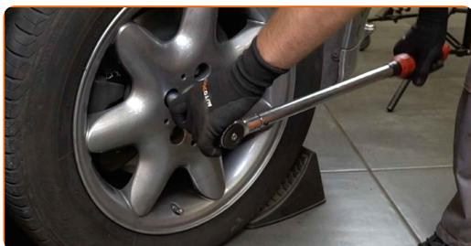
**71** Entfernen Sie den Wagenheber sowie die Unterlegkeile.
