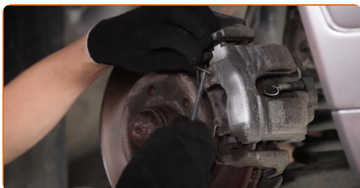
**8** Trennen Sie den Stecker der Verschleißsensoren des Bremsbelags. Verwenden Sie einen flachen Schraubendreher.
