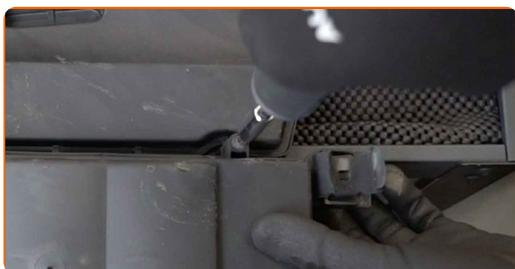
**10** Entfernen Sie den Luftfilterkasten gemeinsam mit den Filterelementen.
