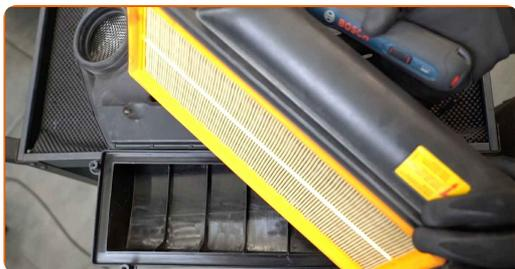
**11** Entfernen Sie die alten Filterelemente.
