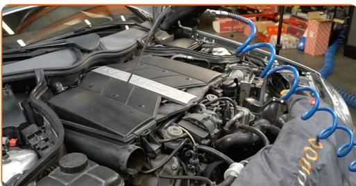
**6** Entfernen Sie das Luftfiltergehäuse.
