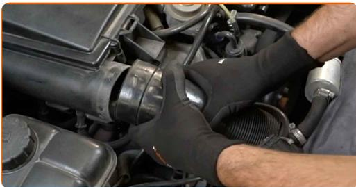
**5** Reinigen Sie die Abdeckung und das Gehäuse des Luftfilters.
