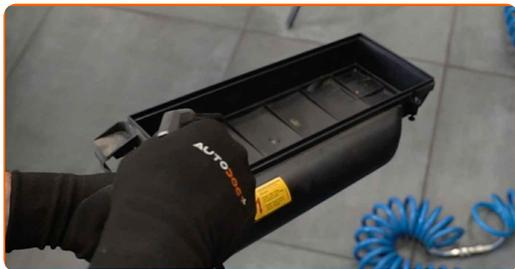
**13** Bauen Sie neue Filterelemente ein. Stellen Sie sicher, dass die Kanten des Filters eng in das Gehäuse passen.
