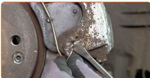
**9** Lösen Sie den Bremsbelagverschleißsensor. Verwenden Sie eine Spitzzange.
