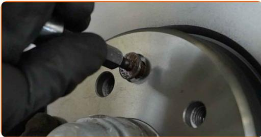
**27** Schrauben Sie die Befestigungen der Bremsscheibe fest. Verwenden Sie Inbusschlüssel Nr. H5. Verwenden Sie einen Drehmomentschlüssel. Ziehen Sie ihn mit 10 Nm Drehmoment fest.
