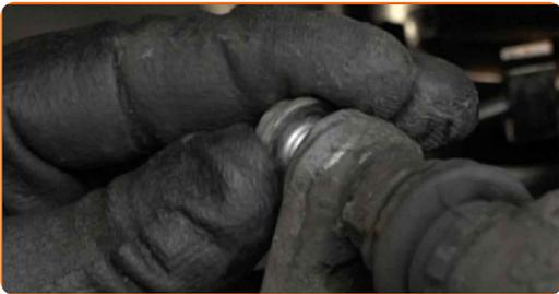
**22** Ziehen Sie die Bremssattelbefestigungen fest. Verwenden Sie Ring-Gabelschlüssel Nr. 17. Verwenden Sie Stecknuss Nr. 13. Verwenden Sie einen Drehmomentschlüssel. Ziehen Sie ihn mit 34 Nm Drehmoment fest.
