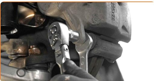
**11** Entfernen Sie die Befestigungsschrauben.
