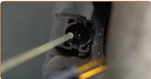
**24** Bringen Sie den Steckverbinder des Verschleißsensors der Bremsbeläge an.
