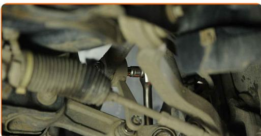
**14** Entfernen Sie die Befestigungsschraube.
