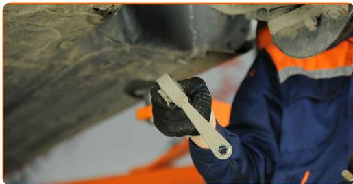
**16** Reinigen Sie die Montagesitze der Koppelstange. Benutzen Sie eine Drahtbürste. Benutzen Sie WD-40-Spray.
