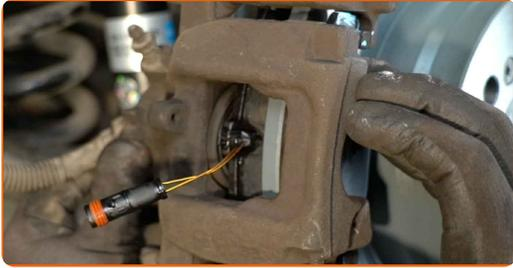
**24** Ziehen Sie die Bremssattelbefestigungen fest. Verwenden Sie Inbusschlüssel Nr. H7. Verwenden Sie einen Drehmomentschlüssel. Ziehen Sie ihn mit 25 Nm Drehmoment fest.
