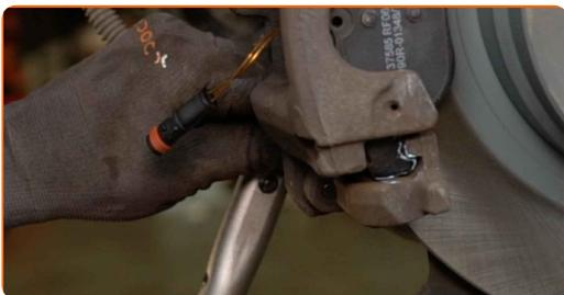
**25** Installieren Sie die Staubschutzkappen der Bremssattel-Führungsstifte.
