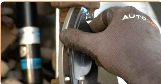
**23** Installieren Sie den Bremssattel und fixieren Sie diesen.
