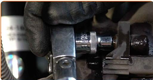
**10** Entfernen Sie die Befestigungsschraube.
