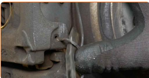
**13** Entfernen Sie die Staubschutzkappen der Bremssattel-Führungsstifte. Benutzen Sie ein Brecheisen.
