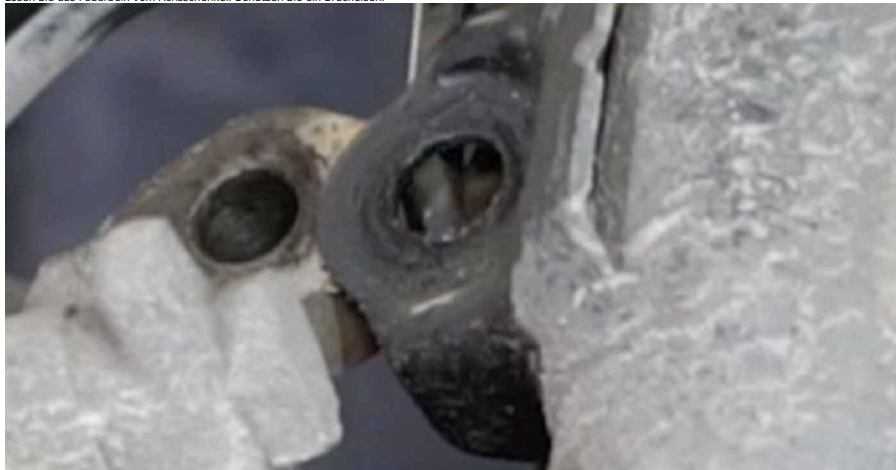
14 Reinigen Sie die Befestigungen der Stabilisatorbuchsenhalter. Benutzen Sie eine Drahtbürste. Benutzen Sie WD-40-Spray.
