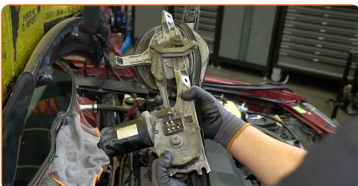
**14** Machen Sie eine Markierung, die den Einbauwinkel des Wischergestänges anzeigt. Verwenden Sie ein Lineal.
