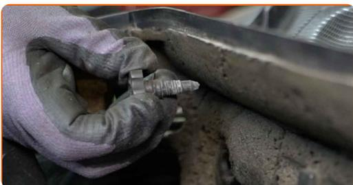
**5** Entfernen Sie das Gummiformteil der Windschutzscheibe.
