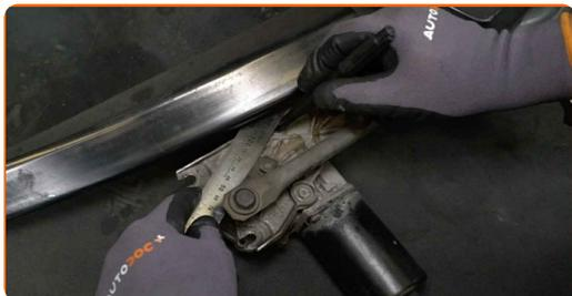
**15** Reinigen Sie die Schraubbefestigungen des Wischermotors. Benutzen Sie eine Drahtbürste. Benutzen Sie WD-40-Spray.
