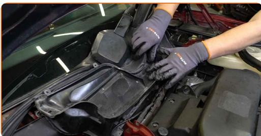
**34** Montieren Sie die seitlichen Wasserabläufe.
