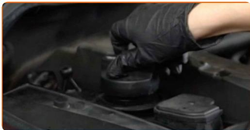
**34** Befestigen Sie den Deckel des Öleinfüllstutzens.
