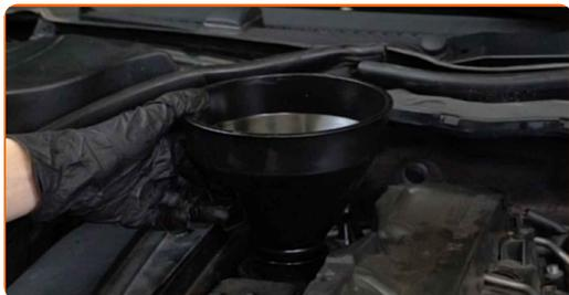
**31** Füllen Sie neues Öl in der vom Fahrzeughersteller empfohlenen Menge in den Motor ein.
