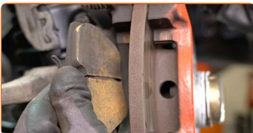
**Austausch: Bremsbeläge – MERCEDES-BENZ E-Klasse T-modell (S124). Tipp von AUTODOC:**
