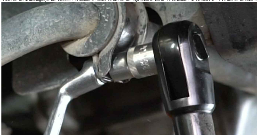
16 Entfernen Sie die Befestigungsschrauben.
