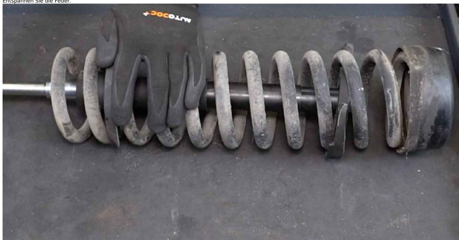
20 Setzen Sie den Federspanner auf die neue Feder.
