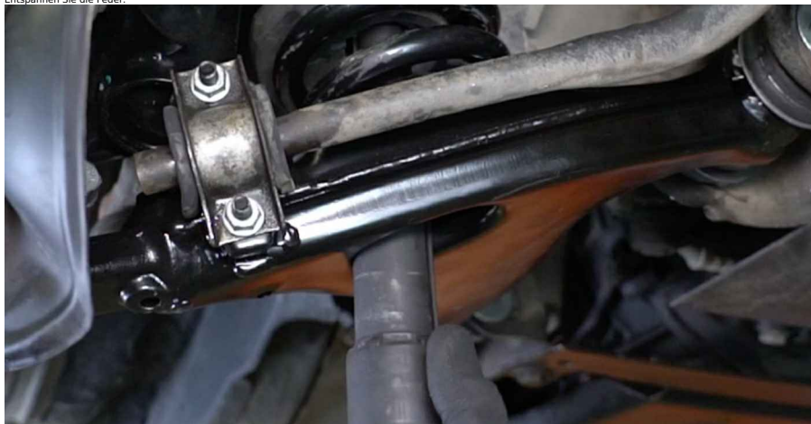
32 Entfernen Sie den Spiralfederspanner.
