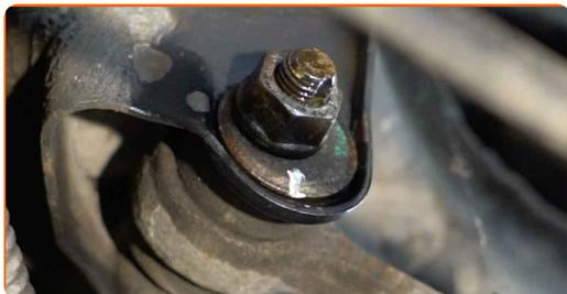
**10** Schrauben Sie die Befestigung ab, die den Querlenker mit dem Hilfsrahmen verbindet. Benutzen Sie den XZN #12. Verwenden Sie Stecknuss Nr. 19. Verwenden Sie ein Windeisen.
