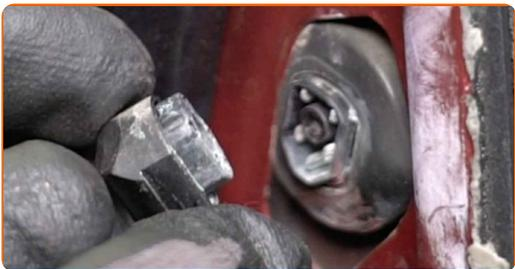
**7** Schrauben Sie die Befestigungsschrauben der Außenspiegel ab. Verwenden Sie einen Kreuzschlitzschraubendreher.
