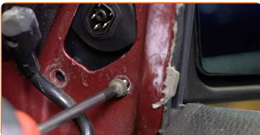
**13** Behandeln Sie den Steckverbinder des Außenspiegels mit einem Kontaktspray. Verwenden Sie dielektrisches Fett.
