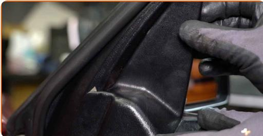
**4** Schrauben Sie die Befestigungsschraube der Steckverbinder des Außenspiegels ab. Verwenden Sie einen Kreuzschlitzschraubendreher.
