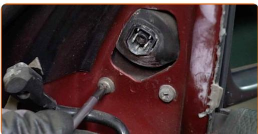
**8** Entfernen Sie die Befestigungsschrauben.
