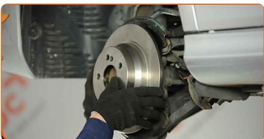
**85** Ziehen Sie die Befestigung der Bremsscheibe fest. Verwenden Sie den Torx T30. Verwenden Sie einen Drehmomentschlüssel. Ziehen Sie ihn mit 9 Nm Drehmoment fest.
