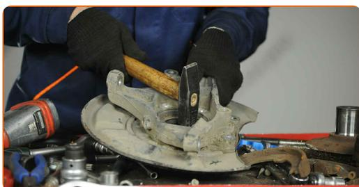
**46** Reinigen Sie den Einbauort für die Nabenlagerung. Benutzen Sie eine Drahtbürste. Benutzen Sie WD-40-Spray.
