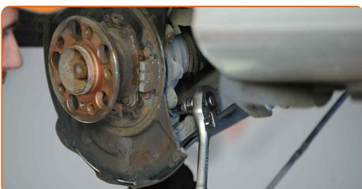
**37** Lösen Sie den Querlenker.
