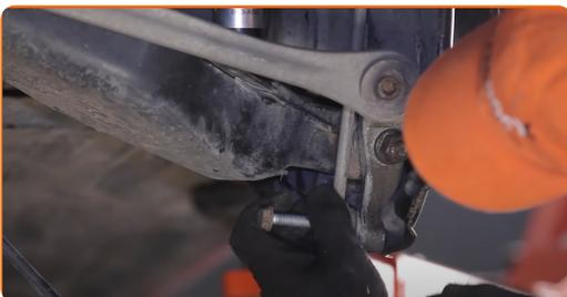
**77** Ziehen Sie die Befestigungselemente des Stabilenkers fest. Verwenden Sie Ring-Gabelschlüssel Nr. 16. Verwenden Sie Stecknuss Nr. 16. Verwenden Sie einen Drehmomentschlüssel. Ziehen Sie ihn mit 50 Nm Drehmoment fest.
