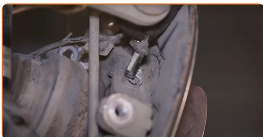
**40** Entfernen Sie die Befestigungsschraube. Verwenden Sie einen Splintentreiber. Benutzen Sie einen Hammer.
