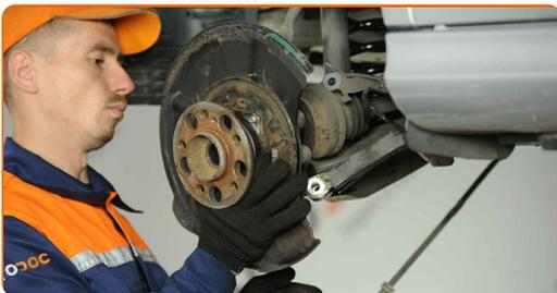
**53** Die Antriebswelle in die Radnabe installieren.
