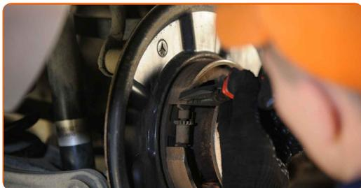
**17** Demontieren Sie die Handbremsschuhe zusammen mit der unteren Feder.
