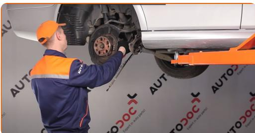
**33** Schrauben Sie die oberen Steuerarmverschlüsse ab. Verwenden Sie Ring-Gabelschlüssel Nr. 18. Verwenden Sie Stecknuss Nr. E18. Verwenden Sie einen Ratschenschlüssel.
