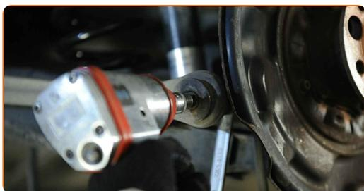
**21** Entfernen Sie die Befestigungsschraube.
