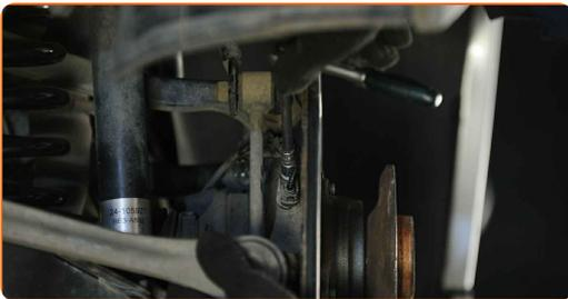
**75** Montieren Sie den Querlenker.
