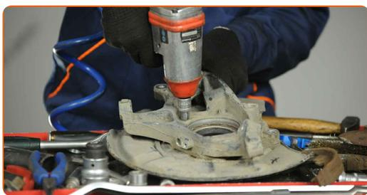
**45** Entfernen Sie die Nabenlagerhalterung. Benutzen Sie einen Hammer.
