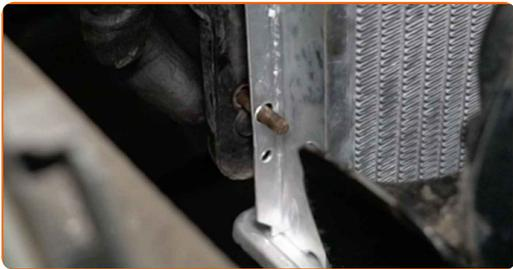
**28** Schrauben Sie die Befestigungen des Lüftergehäuses ein. Verwenden Sie Ring-Gabelschlüssel Nr. 10. Verwenden Sie Stecknuss Nr. 10. Verwenden Sie einen Ratschenschlüssel.
