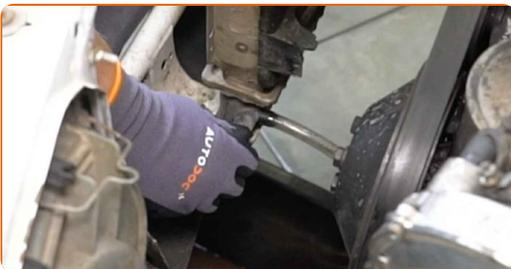
**10** Lösen Sie den oberen Kühlmittelschlauch.
