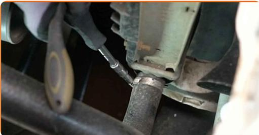
**12** Lösen Sie die untere Kühlmittleitung.
