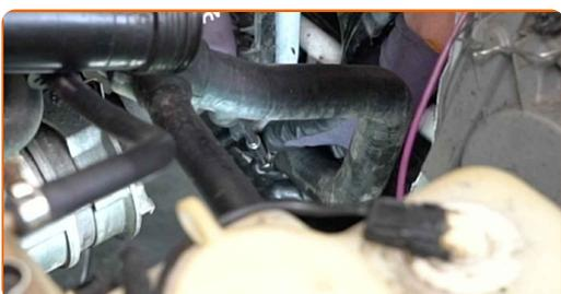
**31** Bringen Sie den oberen Kühlmittelschlauch an.
