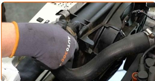
**32** Ziehen Sie die Schelle des oberen Kühlmittelschlauchs fest. Verwenden Sie Stecknuss Nr. 7. Verwenden Sie einen Ratschenschlüssel.
