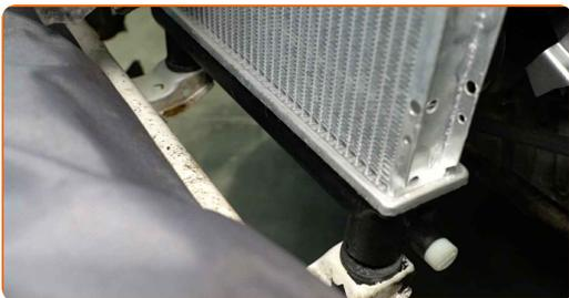
**24** Montieren Sie die oberen Klammern des Motorkühlers.
