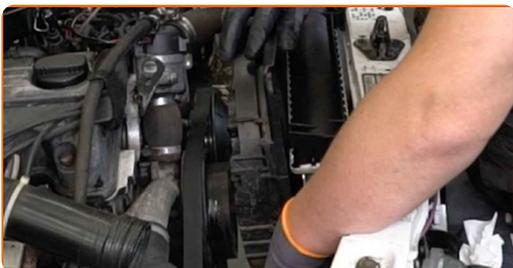
**26** Befestigen Sie die oberen Halteklammern des Lüftergehäuses.
