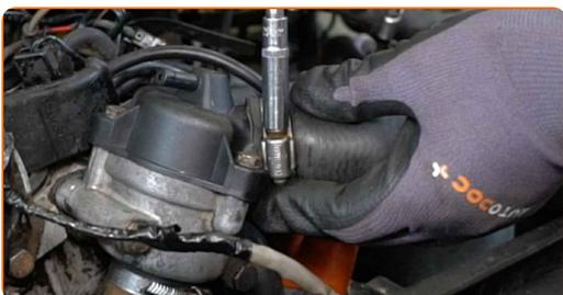
**23** Schließen Sie den Schlauch des Ausgleichsbehälters an das Thermostatgehäuse an.
