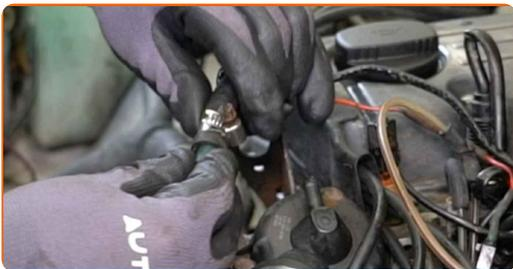
**11** Lösen Sie den Kühlmittelschlauch.
