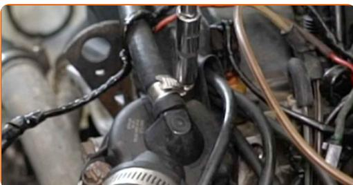
**10** Lösen Sie den Schlauch des Ausgleichsbehälters vom Thermostatgehäuse.
