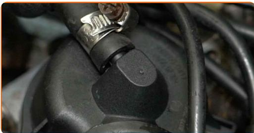
**24** Ziehen Sie die Schelle vom Schlauch des Ausgleichsbehälters fest. Verwenden Sie Stecknuss Nr. 7. Verwenden Sie einen Ratschenschlüssel.
