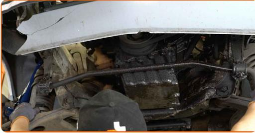
**14** Reinigen Sie alle Verbindungen des Querlenkers. Benutzen Sie eine Drahtbürste. Benutzen Sie WD-40-Spray.
