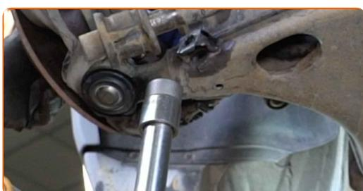
**37** Richten Sie die Position der Sturzschrauben entsprechend den Markierungen aus.
