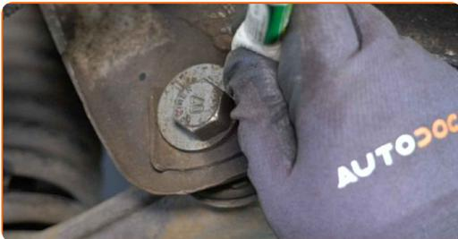
**16** Schrauben Sie die vordere Befestigung des Querlenkers ab. Verwenden Sie Ring-Gabelschlüssel Nr. 22. Verwenden Sie Stecknuss Nr. 22. Verwenden Sie einen Ratschenschlüssel.
