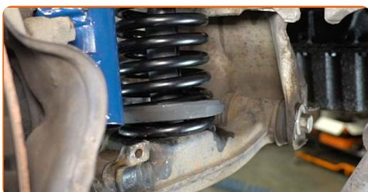
**35** Entfernen Sie den Spiralfederspanner.
