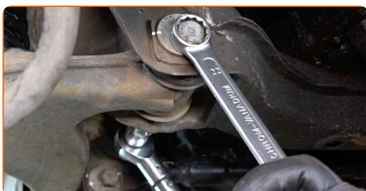
**39** Ziehen Sie das hintere Befestigungselement des Querlenkers an. Verwenden Sie Ring-Gabelschlüssel Nr. 22. Verwenden Sie Stecknuss Nr. 22. Verwenden Sie einen Drehmomentschlüssel. Ziehen Sie ihn mit 120 Nm Drehmoment fest.
