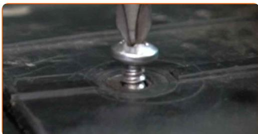
**22** Schrauben Sie die Befestigungsschrauben des Einlassrohrs ein. Verwenden Sie einen Kreuzschlitzschraubendreher. Verwenden Sie Stecknuss Nr. 10. Verwenden Sie einen Ratschenschlüssel.
