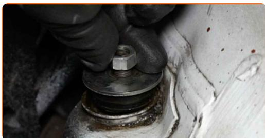
**14** Entfernen Sie die Elemente der oberen Befestigung des Stoßdämpfers.
