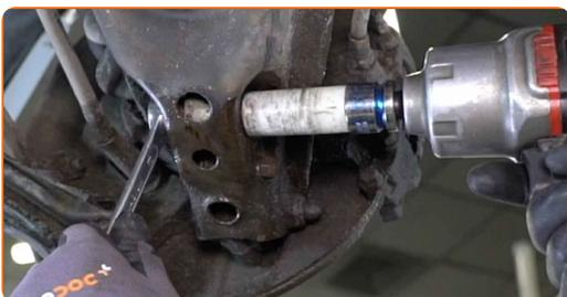
**12** Entfernen Sie die Befestigungsschraube.
