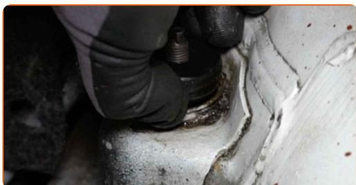
**15** Entfernen Sie den Stoßdämpfer.
