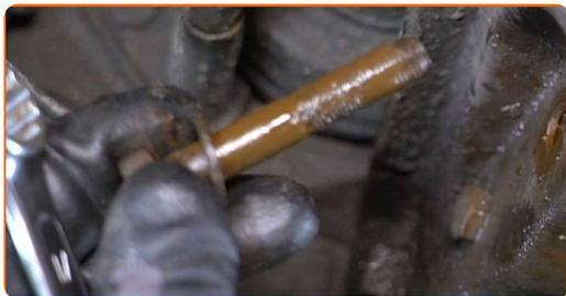
**13** Schrauben Sie die oberen Befestigungen des Stoßdämpfers ab.
