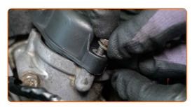
Ziehen Sie die Befestigungselemente des Thermostatgehäuses fest. Verwenden Sie Stecknuss Nr. 10. Verwenden Sie einen Drehmomentschlüssel. Ziehen Sie ihn mit 12 Nm Drehmoment fest.
