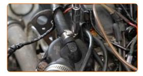
Lösen Sie den Schlauch des Ausgleichsbehälters vom Thermostatgehäuse.
