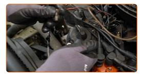
Entfernen Sie den Thermostat zusammen mit dem Gehäuse.
