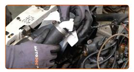
Schrauben Sie die Befestigungselemente des Thermostatgehäuses ab. Verwenden Sie Stecknuss Nr. 10. Verwenden Sie einen Ratschenschlüssel.
