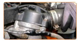
Sichern Sie die Klemme des Kühlmittelschlauchs. Verwenden Sie Stecknuss Nr. 8. Verwenden Sie einen Ratschenschlüssel.
