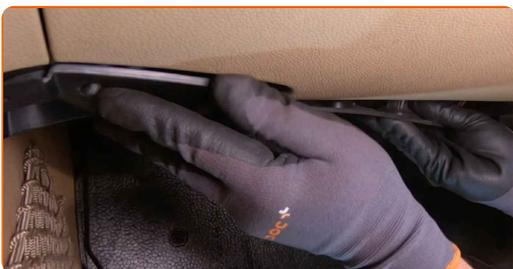
**12** Schrauben Sie die Befestigungen der Einstiegsverkleidung im Fahrgastbereich ein. Verwenden Sie den Torx T20.
