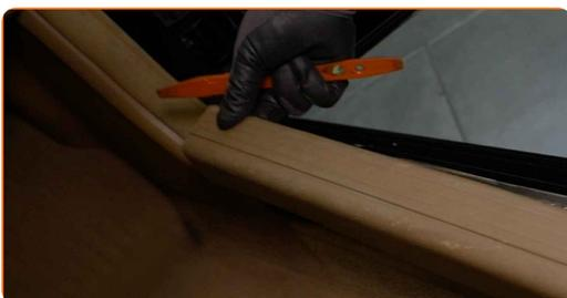
**3** Entfernen Sie den Dichtungsstreifen der Türöffnung.
