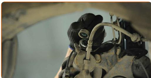
**8** Trennen Sie den Stecker der Verschleißsensoren des Bremsbelags. Verwenden Sie eine Rundzange.
