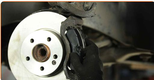
**Austausch: Bremsbeläge – MERCEDES-BENZ Sprinter 3,5-T Kastenwagen (907, 910). Fachleute empfehlen:**
